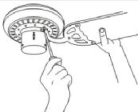
**8.** Закрепите держатели лопастей на корпусе вентилятора с помощью винтов и шайб.
