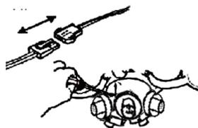
**9.** Соедините два шлейфа, затем закрепите светильник на корпусе вентилятора, с помощью трех винтов. Убедитесь, что Вы не оставили неподключенных проводов.
