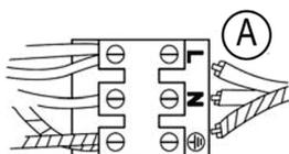
**4.** Подключите провода питания с помощью монтажных клемм по схеме:
