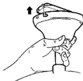
**5.** Прикрепите 4-мя винтами колпак к монтажному кронштейну. Сначала 2 винта прикручиваются через Г-образные пазы, затем еще 2 окончательно фиксируют колпак на монтажном кронштейне.
