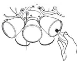
**11.** Вкрутите в патроны лампы (E27, макс. 60Вт). Включите питание и проверьте работу светильника и вентилятора.
