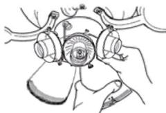
**10.** Установите стеклянные плафоны, закрепив их тремя винтами. **ОСТОРОЖНО:** не затягивайте винты плоскогубцами. Сильно затянутые винты могут повредить стеклянный плафон.
