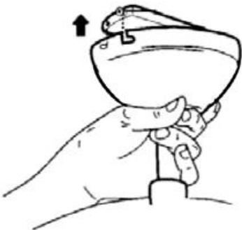
4. Прикрепите 4-мя винтами колпак к монтажной пластине. Сначала 2 винта прикручиваются через Г-образные пазы, затем еще 2 окончательно фиксируют колпак на монтажной пластине.
