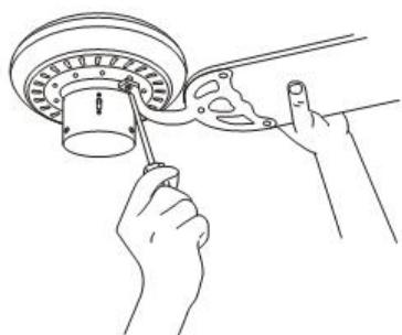
7. Закрепите держатели лопастей на корпусе вентилятора с помощью винтов и шайб.
