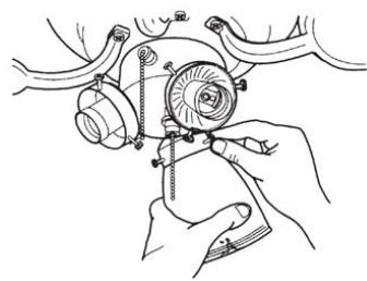
9. Установите стеклянные плафоны, закрепив их тремя винтами. ОСТОРОЖНО: не затягивайте винты плоскогубцами. Сильно затянутые винты могут повредить стеклянный плафон.
