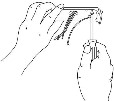
1. Пропустите провода питания сквозь отверстие в монтажной пластиине, надежно закрепите монтажную пластиину к потолку с помощью шурупов, пружинных и плоских шайб.
