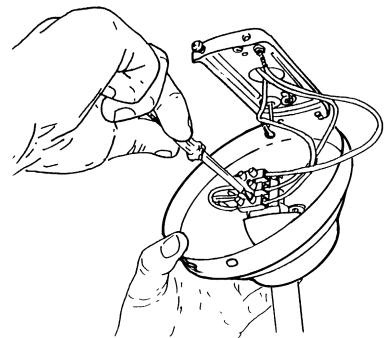
3. Подключите провода питания с помощью монтажных клемм по схеме:
