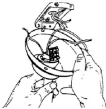
2. Просуньте штангу вентилятора через колпак. Проденьте провода от корпуса вентилятора через штангу.
