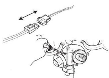
8. Соедините два шлейфа, затем закрепите светильник на корпусе вентилятора.
