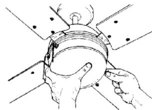
9. Установите стеклянный плафон, закрепив его тремя винтами. ОСТОРОЖНО: не затягивайте винты плоскогубцами. Сильно затянутые винты могут повредить стеклянный плафон.
