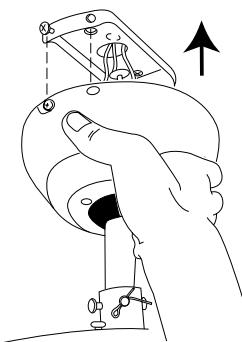
4. Прикрепите 4-мя винтами колпак к монтажной пластине. Сначала 2 винта прикручиваются через Г-образные пазы, затем еще 2 окончательно фиксируют колпак на монтажной пластине.
