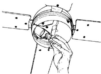
8. Установите лампу (E14, макс. 60Вт) в патрон. Включите питание и проверьте работу светильника и вентилятора.
