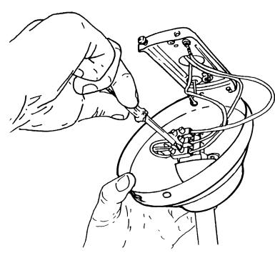
3. Просуньте штангу вентилятора через колпак. Проденьте провода от корпуса вентилятора через штангу. Подключите провода питания с помощью монтажных клемм по схеме:
