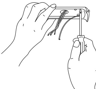
2. Пропустите провода питания сквозь отверстие в монтажной пластине, надежно закрепите монтажную пластину к потолку с помощью шурупов, пружинных и плоских шайб.
