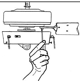
7. Закрепите держатели лопастей на корпусе вентилятора с помощью винтов и шайб.
