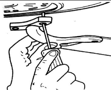
6. Закрепите держатели лопастей на корпусе вентилятора с помощью винтов и шайб.
