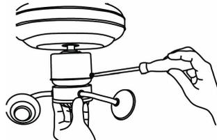
9. Установите светильник на вентилятор, закрепив его тремя винтами
