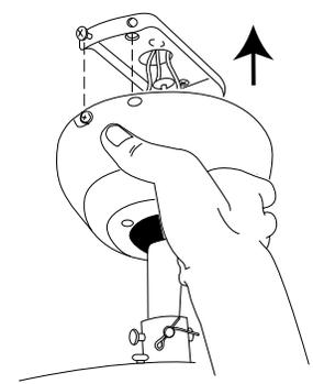
**3.** Прикрепите 4-мя винтами колпак к монтажной пластине. Сначала 2 винта прикручиваются через Г-образные пазы, затем еще 2 окончательно фиксируют колпак на монтажной пластине.
