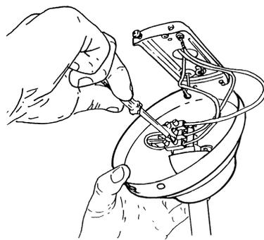
**2.** Просуньте штангу вентилятора через колпак. Проденьте провода от корпуса вентилятора через штангу. Подключите провода питания с помощью монтажных клемм по схеме:
