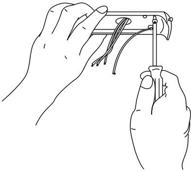
**1.** Пропустите провода питания сквозь отверстие в монтажной пластине, надежно закрепите монтажную пластину к потолку с помощью шурупов, пружинных и плоских шайб.
