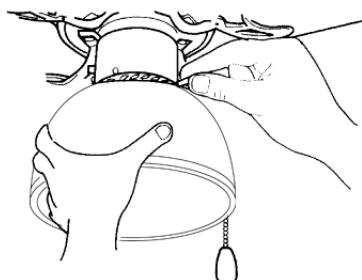
9. Установите стеклянный плафон на светильник, закрутив его с помощью трех винтов.
