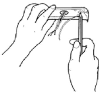
1. Пропустите провода питания сквозь отверстие в монтажной пластине, надежно закрепите монтажную пластину к потолку с помощью шурупов, пружинных и плоских шайб.
