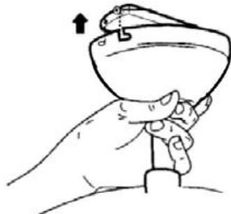
4. Прикрепите 4-мя винтами колпак к монтажной пластине. Сначала 2 винта прикручиваются через Г-образные пазы, затем еще 2 окончательно фиксируют колпак на монтажной пластине.
