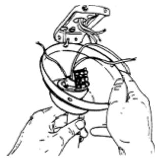
2. Просуньте штангу вентилятора через колпак. Проденьте провода от корпуса вентилятора через штангу.
