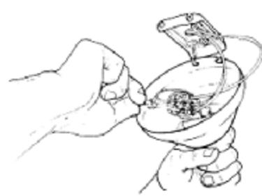
3. Подключите провода питания с помощью монтажных клемм по схеме:
