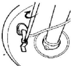
4. Ослабьте винт в кронштейне. Вставьте инфра-красный датчик в отверстие колпака. Убедитесь, что датчик прикреплен, как показано на рисунке и затяните винт.
