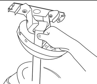
2. Просуньте штангу вентилятора через колпак. Проденьте провода от корпуса вентилятора через штангу.
