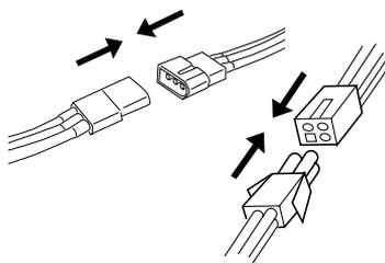
5. Соедините электрические шлейфы в соответствии с инструкцией по монтажу приемного устройства дистанционного управления.
