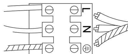
6. Подключите провода питания с помощью монтажных клемм по схеме:
