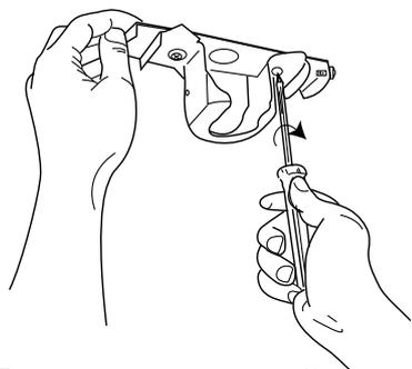
1. Прикрепите кронштейн к потолку с помощью двух шурупов, пружинных и плоских шайб.
