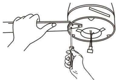
8. Закрепите лопасти вентилятора на корпусе с помощью винтов плоских и пружинных шайб.
