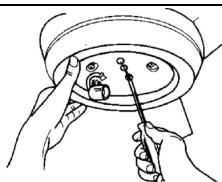
10. Прикрепите светильник к вентилятору с помощью трех винтов и пружинных шайб. Убедитесь, что Вы не оставили не подключенных проводов.
