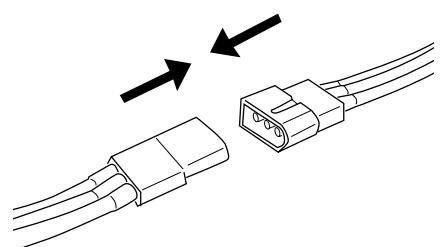
9. Соедините шлейфы между вентилятором и светильником.
