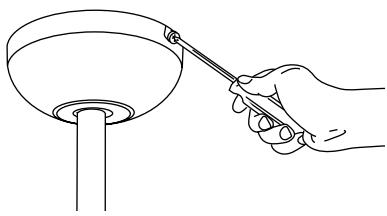
7. Прикрепите 4-мя винтами колпак к кронштейну. Сначала 2 винта прикручиваются через Г-образные пазы, затем еще 2 окончательно фиксируют колпак на кронштейне.
