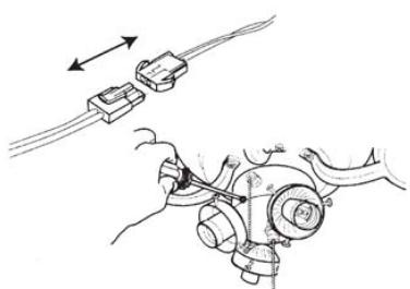
9. Соедините два шлейфа, затем закрепите светильник на корпусе вентилятора, с помощью трех винтов. Убедитесь, что Вы не оставили неподключенных проводов.
