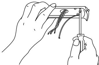
2. Пропустите провода питания сквозь отверстие в монтажной пластине, надежно закрепите монтажную пластину к потолку с помощью шурупов, пружинных и плоских шайб.
