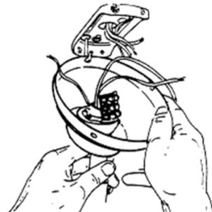
3. Просуньте штангу вентилятора через колпак. Проденьте провода от корпуса вентилятора через штангу.
