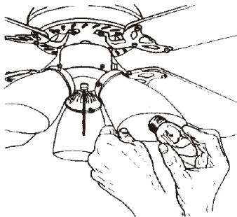
11. Вкрутите в патроны лампы (E27, макс. 60Вт). Включите питание и проверьте работу светильника и вентилятора.
