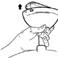
5. Прикрепите 4-мя винтами колпак к монтажной пластине. Сначала 2 винта прикручиваются через Г-образные пазы, затем еще 2 окончательно фиксируют колпак на монтажной пластине.
