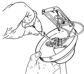
4. Просуньте штангу вентилятора через колпак. Проденьте провода от корпуса вентилятора через штангу. Подключите провода питания с помощью монтажных клемм по схеме:
